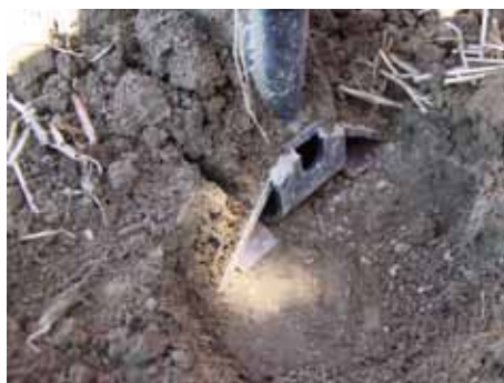
To striper: Vingesålabbene er utformet slik at såkornet blåses ut i to striper, med 10-12 centimeters mellomrom.
