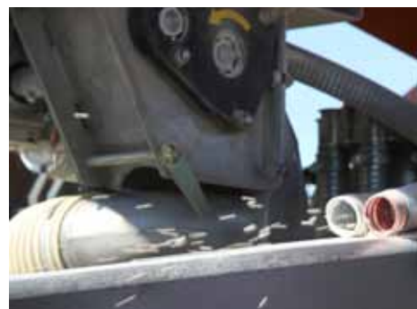
Indikerer feil: Tettes av slangene, eller blir det på andre måter noe feil med utmating av såkorn eller gjødsel, blåses dette fram i en slange som sjåføren kan holde et øye med.
